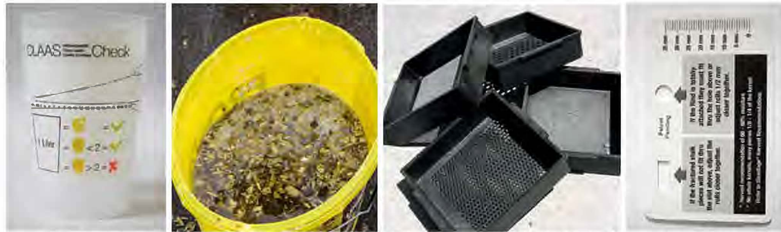
Von links: Das Litermaß von Claas ist mit den Maß- und Kennzahlen bedruckt. Der Wassertest eignet sich besonders zur Kontrolle der Kornaufbereitung. Die Schüttelbox hilft beim Prüfen auf eine gleichmäßige Aufbereitung. Der Shredlage Harvest Guide beurteilt den Stängelaufschluss.
